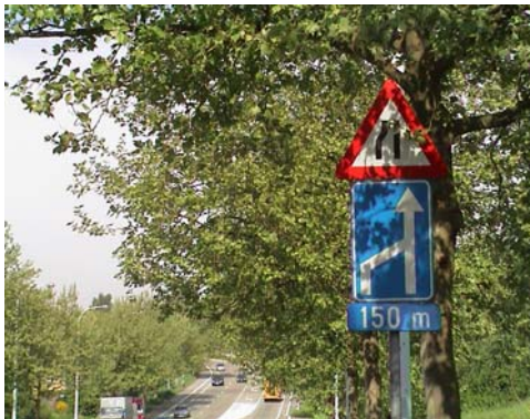
Foto 5.50 Rijbaanversmalling met verkeersbord A7b en onderbord 9a
